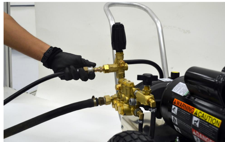
Conexión de la manguera de ¼" para la pistola M407
