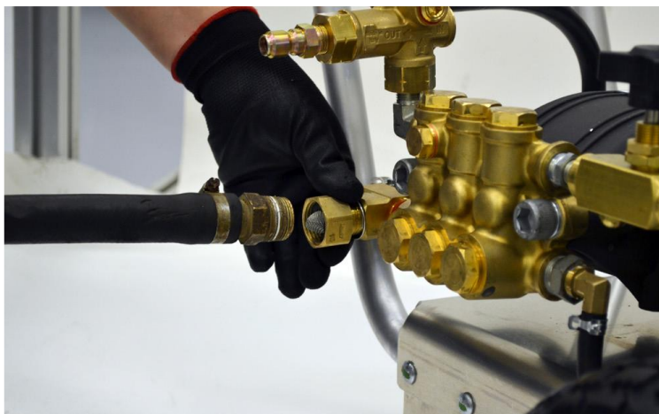
Conexión con el suministro de desinfectante
